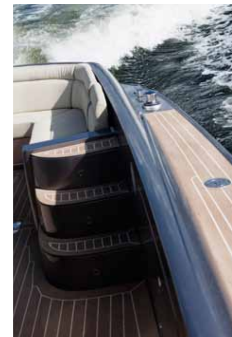
onder: Verlichte traptreden en een lier om het achteruit meren in de Med te vergemakkelijken
