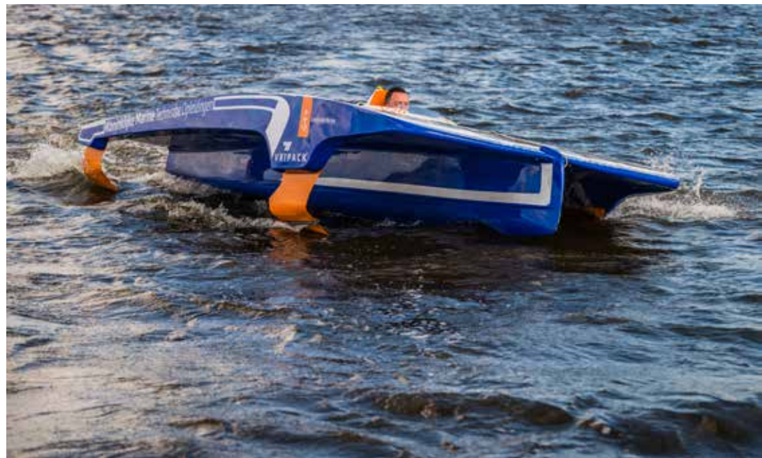
Boven: De draag- vleugels van de V20 creëren lift.
